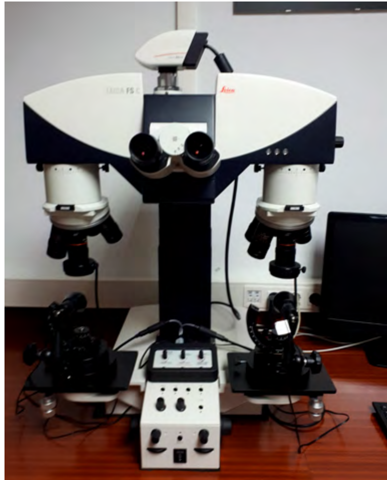
Microscopio de Comparación del Laboratorio de Criminalística, usado en balística.
