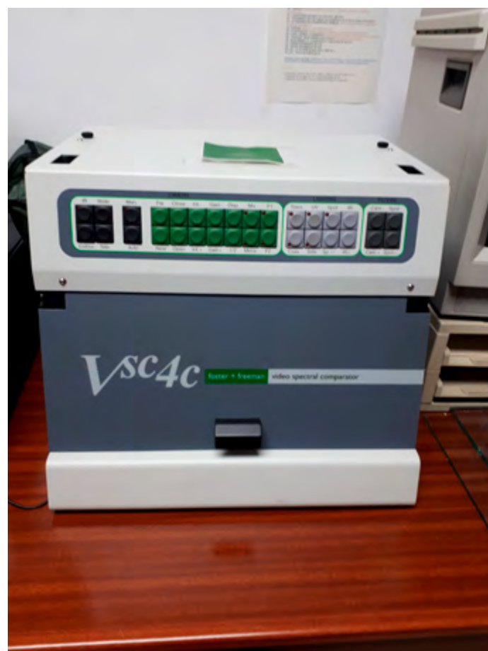
Espectrómetro utilizado para la detección de moneda falsa.
