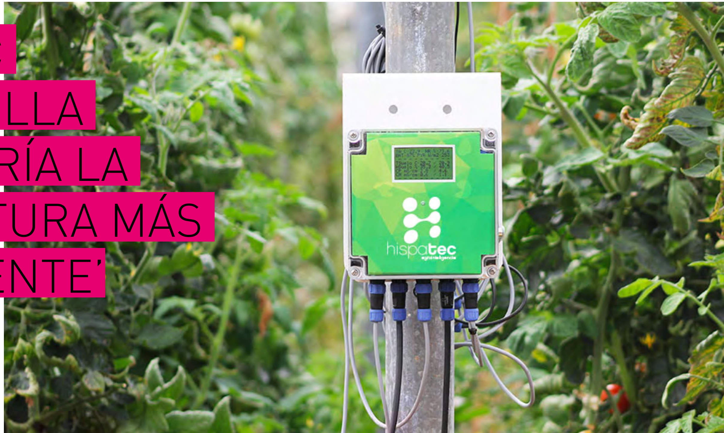
Dispositivo Hortisys para el control en tiempo real del estado de los cultivos combinando con datos meteorológicos tanto de interior de invernadero como de exterior y regionales.
