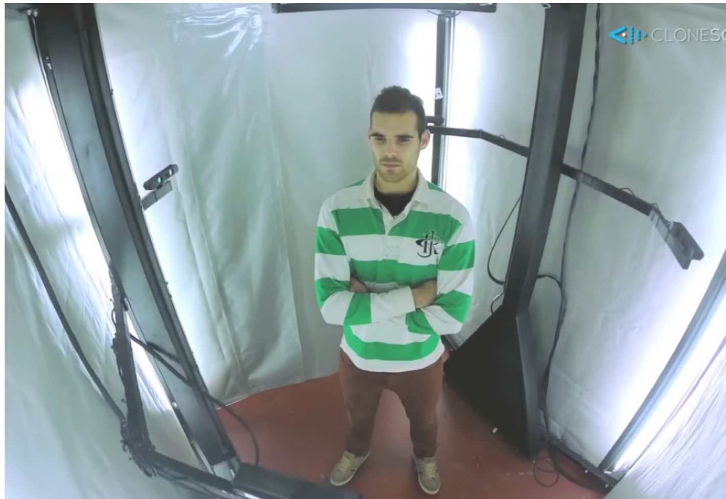
Interior del nuevo escáner Clonescan 3D, dedicado a biometría, control médico del peso corporal o confección de prendas a medida, entre otros usos.
